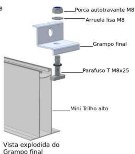
Figura 6 – Estrutura metálica de suporte para módulos fotovoltaicos em telhado
